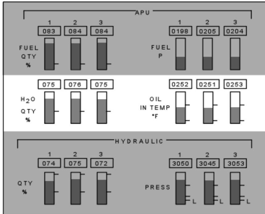
**Figure 4-9. HYD/APU Subsystem Status Display meters**
